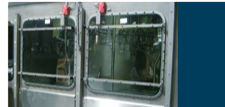
Revisionsfenster für Reinigungsanlagen, druckdicht (gegen Lauge bzw. Gase).
