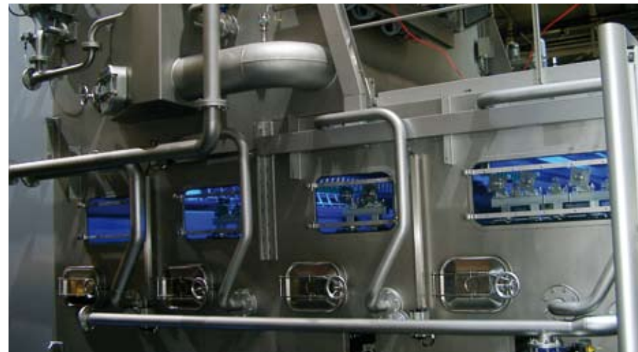
Rahmenlose Klappfenster in einer Flaschenreinigungsanlage.
